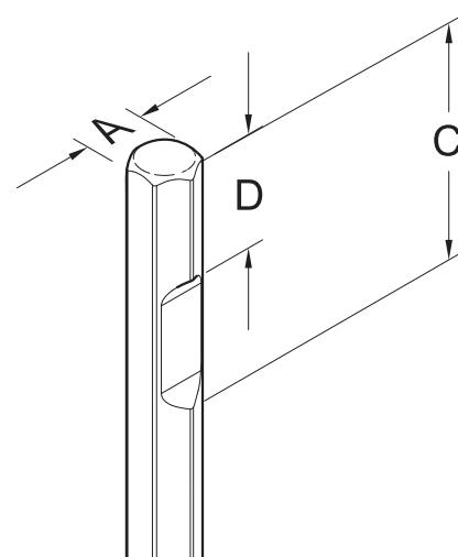
Χρησιμοποιήστε το διακενόμετρο που αντιστοιχεί στη διάσταση στελέχους του εργαλείου εισαγωγής. Βλ. ενότητα «Τεχνικά δεδομένα» για τις σωστές διαστάσεις του στελέχους του εργαλείου.
