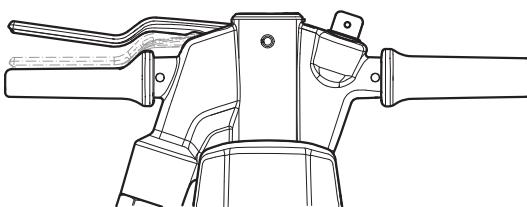
Σταματήστε τη λειτουργία του αεροθραυστήρα ελευθερώνοντας τη σκανδάλη. Η σκανδάλη θα επανέλθει αυτόματα στη θέση τερματισμού λειτουργίας.
