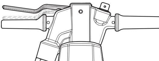
Başlatma ve durdurma düğmesini bırakarak havalı kıricıyı durdurun. Başlatma ve durdurma düğmesi otomatik olarak durma konumuna dönecektir.
