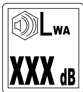
Etiket garanti edilen gürültü seviyesinin EC direktifi 2000/14/EC ile uyumlu olduğunu belirtmektedir. Kesin gürültü seviyesi için "Teknik özellikler" bölümünü bakın.
