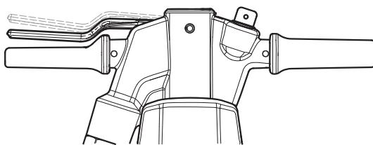
Druk licht op de start- en stopvoorziening voor het activeren van de SOFSTART om van begin af aan een goede grip op het oppervlak te krijgen.
