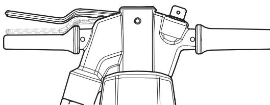
Zatrzymaj młot pneumatyczny zwalniając mechanizm uruchamiający i zatrzymujący. Mechanizm uruchamiający i zatrzymujący powróci automatycznie do położenia zatrzymania.
