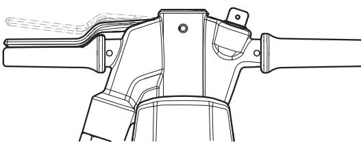
Συνεχίστε να πιέζετε τελείως κάτω τη διάταξη έναρξης και διακοπής λειτουργίας για να ενεργοποιήσετε την πλήρη ισχύ της πνευματικής σφύρας.
