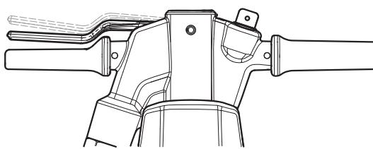
Легко нажмите кнопку пуска и остановки устройства для задействования МЯГКОГО ПУСКА, чтобы позволить оператору надежно взять инструмент в начале работы.
