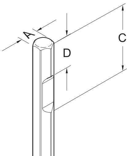
Utilice el calibrador que se corresponda con la dimensión del vástago de la herramienta de inserción. Consulte el apartado "Datos técnicos" para saber las dimensiones correctas del vástago de la herramienta.
