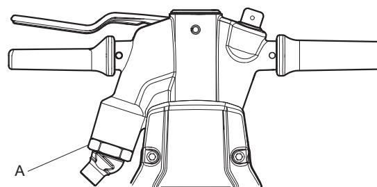
A. Écrou tournant, 280 Nm
