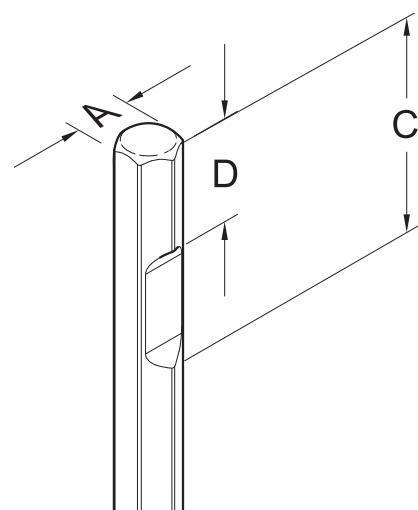
Brug måleværktøjet, der svarer til dimensionen på indsætningsværktøjets skaft. I afsnittet "Tekniske data" kan du finde de korrekte mål på værktøjsskaftet.
