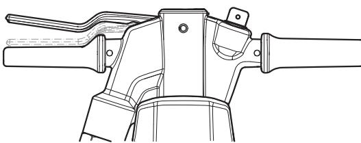
Pare el rompedor soltando el gatillo. El gatillo regresará automáticamente a la posición de parada.
