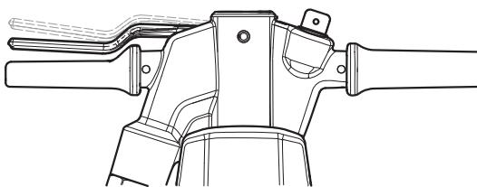
Premere leggermente il dispositivo di avviamento e di arresto per attivare il SOFSTART, in modo da avere una buona presa sulla superficie da lavorare, fin dall'inizio.
