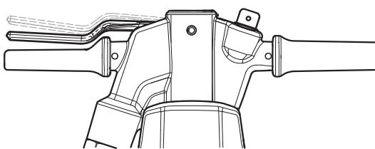
Pressione levemente o dispositivo de arranque e paragem para ativar o SOFSTART, para obter uma boa aderência na superfície desde o início.
