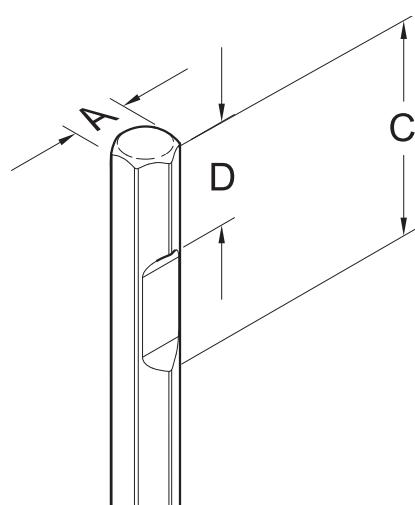
Verwenden Sie die für die Werkzeugschaftgröße passende Lehre. Die korrekten Werkzeugschaftabmessungen finden Sie unter „Technische Daten“.
