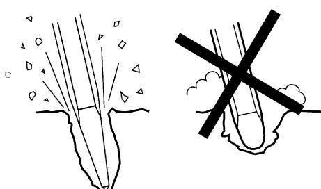
Çalışma ucu çapına tekabül eden gösterge kullanın. Doğru uç yapıları için "Teknik özellikler" bölümune bakın.
