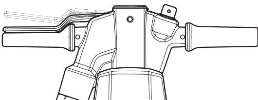
Drücken Sie den Start- und Stoppschalter voll durch, um den Drucklufthammer mit maximaler Leistung zu betreiben.
