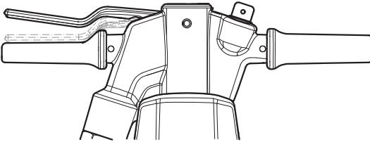
Stop tryklufthammeren ved at slippe udløseren. Udløseren går automatisk tilbage til stopstillingen.
