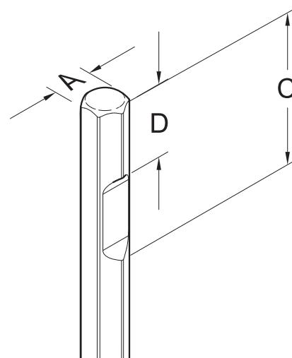
Utilisez un calibre qui correspond à la dimension de la tige de l'outil d'insertion. Voir la section « Caractéristiques techniques » pour connaître les dimensions de tige correctes.
