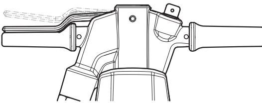
Continuare a premere il dispositivo di avviamento e di arresto fino in fondo per attivare il demolitore idraulico alla massima potenza.
