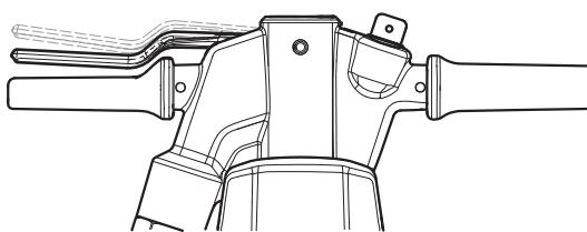
Πιέστε ελαφρά τη διάταξη έναρξης και διακοπής λειτουργίας για να ενεργοποιήσετε τη λειτουργία SOFSTART, ώστε να αποκτήσετε καλή πρόσφυση στην επιφάνεια από την αρχή.
