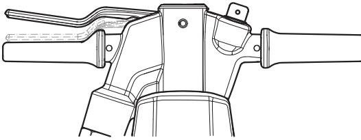
Arrestare il demolitore pneumatico rilasciando il dispositivo di azionamento. Il dispositivo di azionamento torna automaticamente nella posizione di arresto.
